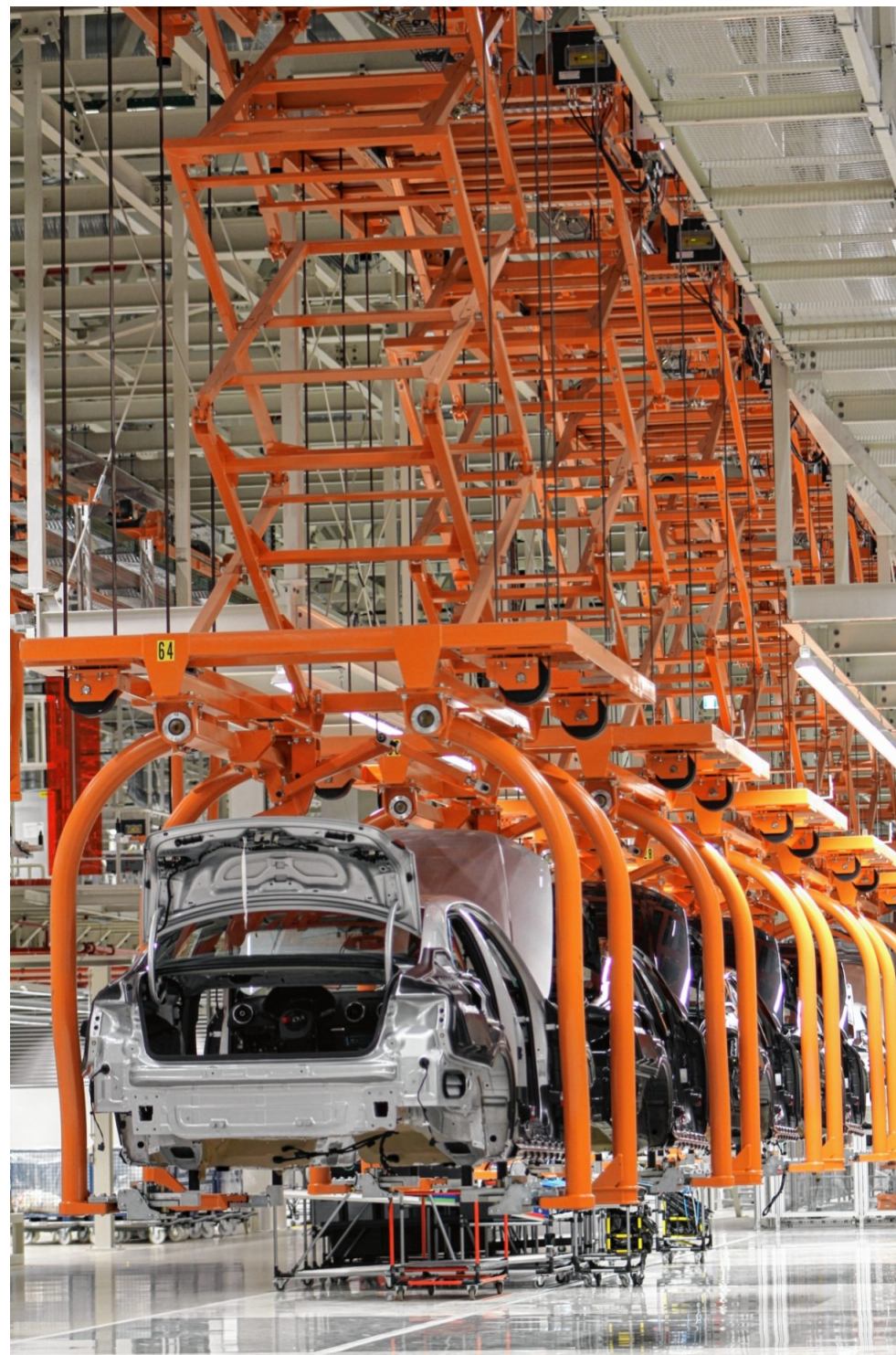
Die Rofa-Gruppe hat sich auf die Entwicklung und Produktion von Fördertechnik wie dieses in der Automobilbranche eingesetzte Schwerlast-Elektrohängebahn-Gehänge spezialisiert.
